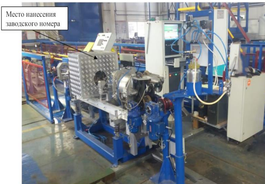
Рисунок 44 - Общий вид установки неразрушающего контроля с системой обнаружения дефектов
