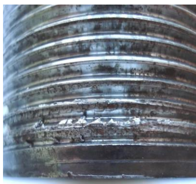
Рисунок 23 – Забоины на торце
