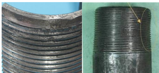
а – дефекты поверхности резьбы; б – искажение геометрии резьбового конца трубы
