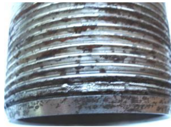
Рисунок 16 - Задиры в начальных витках резьбы
