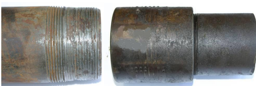
Рисунок 12 – Смятие витков резьбы ниппеля
