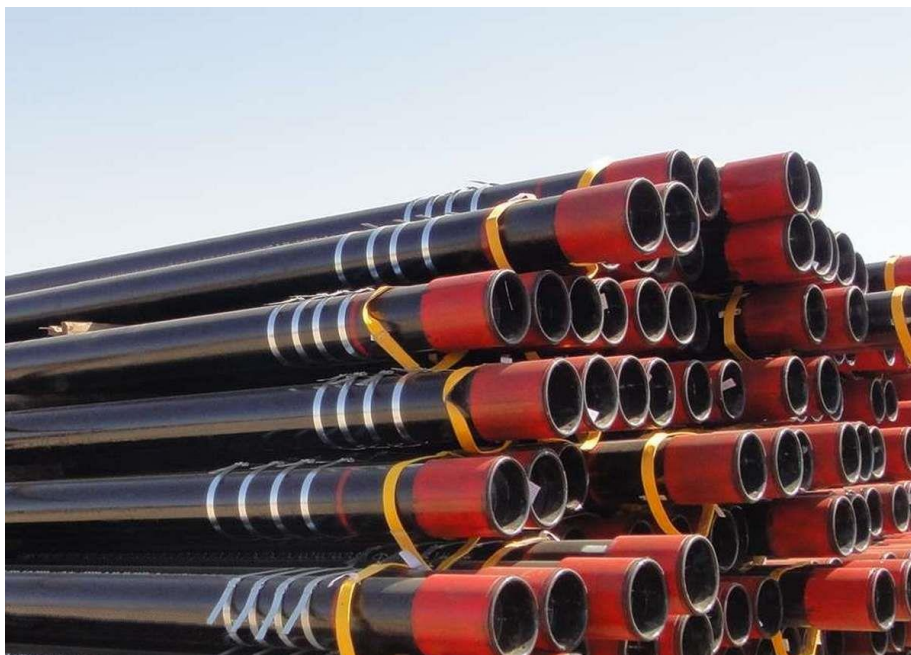
Рисунок 1 – Насосно - компрессорные трубы
