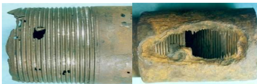
а – сквозная коррозия на резьбе; б – коррозионное разрушение тела муфты
