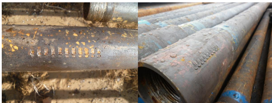
Рисунок 14 – Задиры на теле трубы и муфты
