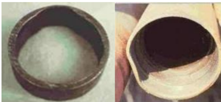
а – изменение толщины стенки трубы; б – смятие муфты
