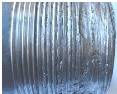
Рисунок 11 – Смятие витков резьбы ниппеля
