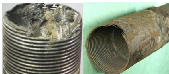
а – коррозионное разрушение на поверхности резьбы; б – коррозионное разрушение резьбы муфты
